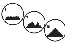
Si vous tournez vers la droite en partant de Démarrage rapide, vous parvenez aux profils d'entraînements 1 à 6. Dans les profils d'entraînement, l'appareil de sport modifie automatiquement le niveau de freinage conformément au profil. Les modifications des niveaux de freinage sont alors modérées dans les profils 1 à 3, exigeants dans les profils 4 à 6. Après sélection d'un profil d'entraînement, déterminez encore la durée d'entraînement et démarrez ensuite l'entraînement.
