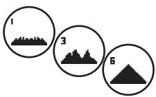
Draait u uitgaand van de snelstart naar rechts, belandt u in de profieltrainingen 1 – 6. In de profiel-trainingen wijzigt het sportapparaat het remniveau automatisch, conform het profiel. Daarbij zijn de remniveau-wijzigingen in de profielen 1-3 gematigd, in de profielen 4-6 intensief. Na het kiezen van een profieltraining bepaalt u nog de trainingsduur en start dan uw training.
