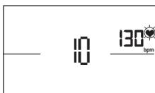
Tryk på restitutionsknappen under **træning med aktiv pulsmåling**. Efter 10 sekunder starter målingen.
