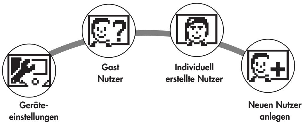
Beim Gerätetestart gelangen Sie nach einer kurzen Begrüßung in das Startmenü. In diesem Menü wird vornehmlich der Nutzer ausgewählt, auf dessen Konto trainiert werden soll. Darüber hinaus können Sie einen neuen Nutzer anlegen und unter dem Punkt "Geräteeinstellungen" nutzerübergreifende Grundeinstellungen vornehmen.
