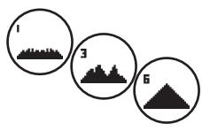
Eseguendo una rotazione verso destra a partire dall'avvio rapido si accede ai profili di allenamento 1 – 6. Nei profili di allenamento l'attrezzo sportivo modifica automaticamente il livello di frenatura in base al profilo. Le variazioni del livello di frenatura sono moderate nei profili 1-3, mentre sono impegnative nei profili 4-6. Dopo aver selezionato un profilo di allenamento occorre stabilire ancora la durata dell'allenamento e poi si può iniziare.
