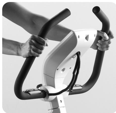
Styrets hældning kan indstilles. Løsn skruen under cockpitet og indstil din optimale position. Stram derefter skruen igen, så styret ikke glider igennem.
