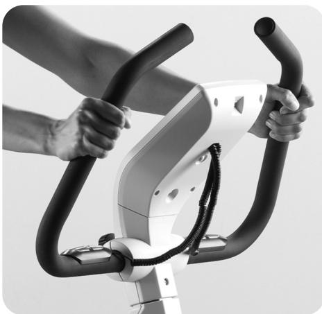
Il manubrio del proprio hometrainer si lascia inclinare. Allentare la vite sotto il cockpit e impostare la posizione ottimale per la propria costituzione. Poi serrare nuovamente la vite per impedire che il manubrio si sposti.
