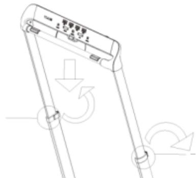
Schritt 3 Lösen Sie die Knöpfe der linken und rechten Verriegelung der Säulen gegen den Uhrzeigersinn und denken Sie daran, die Säulen ständig in einer Hand zu halten, um ein unkontrolliertes Verrutschen zu vermeiden. Senken Sie die Säulen langsam mit der Konsole ab und sichern Sie dann beide Drehknöpfe.
