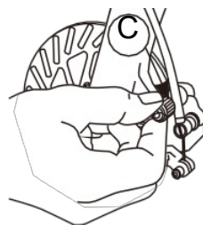
Obr. 15 Seřízení brzdových destiček kotoučových brzd
