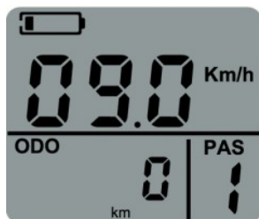
Indikátor nízkeho napätia
