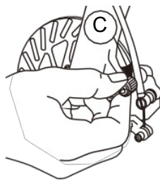
Obr. 15 Nastavenie brzdových doštičiek kotúčových brzd
